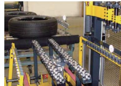
能够自动调整轮胎胎中的带胎圈润滑装置的润滑工位
