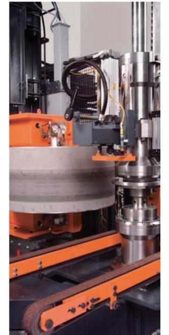
负荷轮和轮辋便于接触，从而可轻松执行轮辋更换和维护
