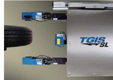
采用“线激光”技术的可选轮胎几何外观检查系统 (TGIS-SL®)
